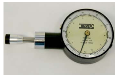
Druckalgometer, FDN 100, Wagner Instr. Stimulusintensität von 0 bis 1000 kPa
